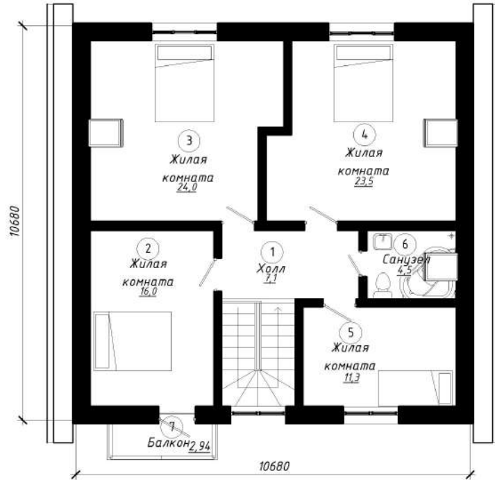
Архитектурный план мансардного этажа на отм. +3,100
